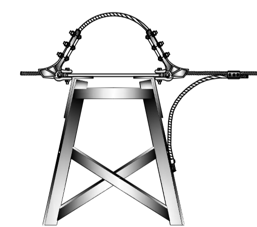
Conjunto de Ancoragem do Cabo Para-Raios
